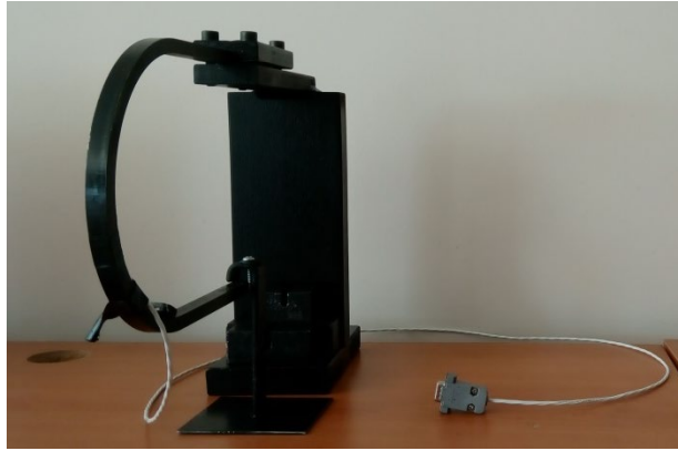
Yarım Daire Bükülmüş Kirişte Yarıçap ve Yük Ölçüm Deneyi Seti
